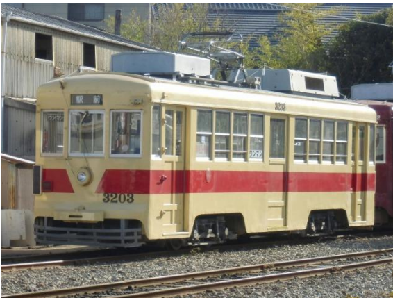
全長:12,325mm 最高速度 40km/h 主電動機:TB-28A(37.3kW) 抵抗制御
