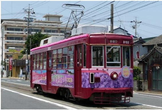
全長:12,325mm 最高速度 40km/h 主電動機:TB-28A(37.3kW) 抵抗制御
